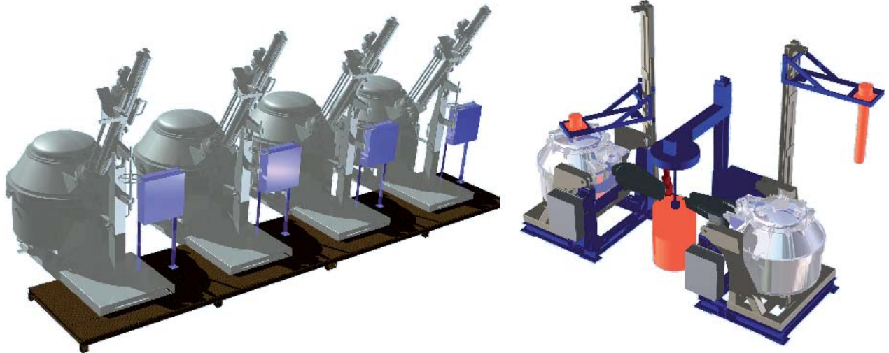
Bild 4: Prinzipielle Darstellung einer Aufstellungsvariante für vier Warmhaltestationen (elektrisch beheizt) und zwei Kippvorrichtungen in einer Gießerei
