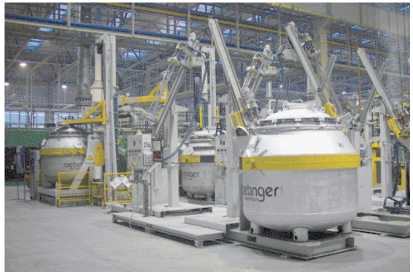
Bild 5: Integrierte Flüssigmetallversorgung der Gießerei Starcam in Tschechien
